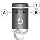
La télécommande dispose de 2 boutons et un voyant d'indication visuelle de fonctionnement ainsi que d'un buzzer retour sonore.
