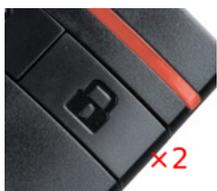
La double impulsion sur une touche permet d'activer des fonctions secondaires (contrôle de sorties programmables etc.)
